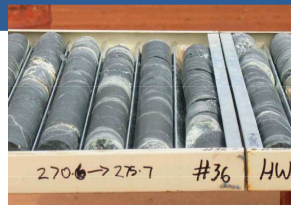
ボーリングコア
